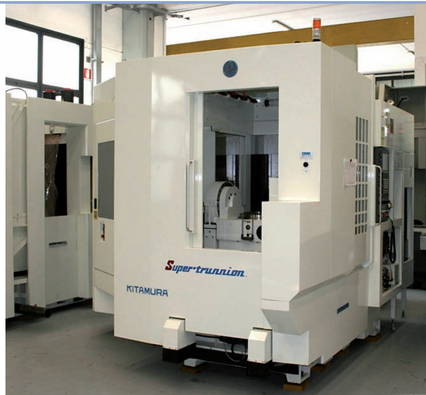
Il centro di lavoro della Kitamura ad alta precisione a 5 assi Super-trunnion esposto nello stabilimento di Stezzano (BG) della GMV Macchine Utensili S.p.A.
