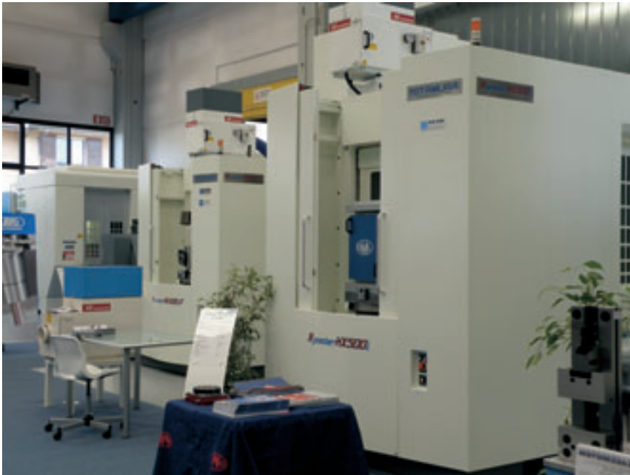
Kitamura costruisce centri orizzontali per la lavorazione fino a 5 assi, con pallet di dimensioni da 250 fino a 1.000 mm
