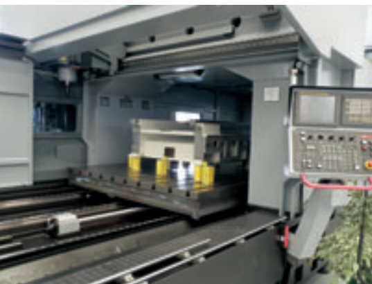
Robusto centro verticale a doppia colonna di fabbricazione Wele (Taiwan), con corse 3.060 mm in X, 2.150 mm in Y e 800 mm in Z, adatto alla lavorazione di strutture e basamenti
